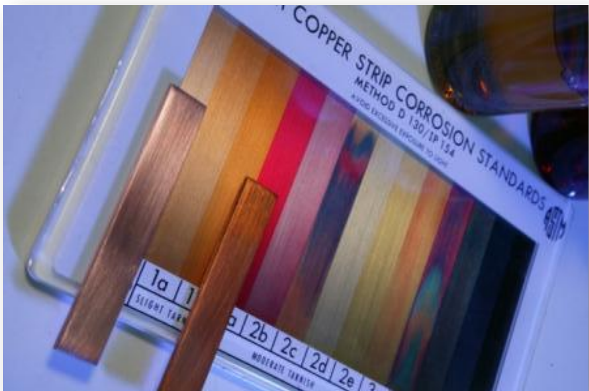
Annexe A16 : Table de séries des couleurs de référence de la corrosion à la lame de cuivre.
