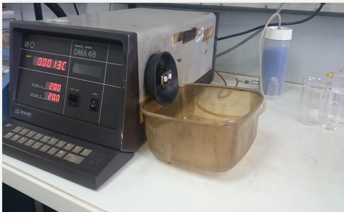
Annexe A2 : Densimètre électronique à tube en U oscillant
