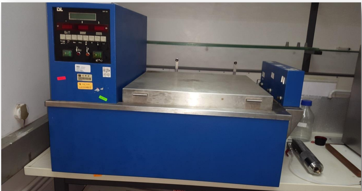
Annexe A3 : Bain thermostaté pour la viscosité cinématique manuelle (type de capillaire : CANNON FENSKE).
