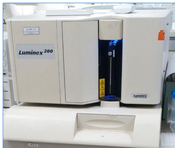
Figure 16 : Appareil de lecture de la fluorescence de marque Luminex.
