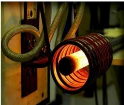
Figure I-12 Réchauffage des barres.
