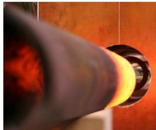
Figure I-13 Réchauffage des tubes.
