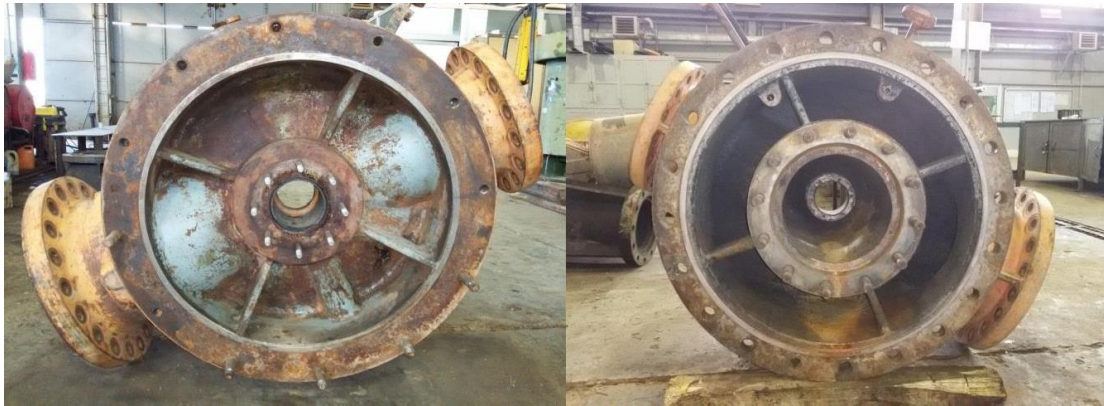
Figure II.22: tubulures d'aspiration et de refoulement.
