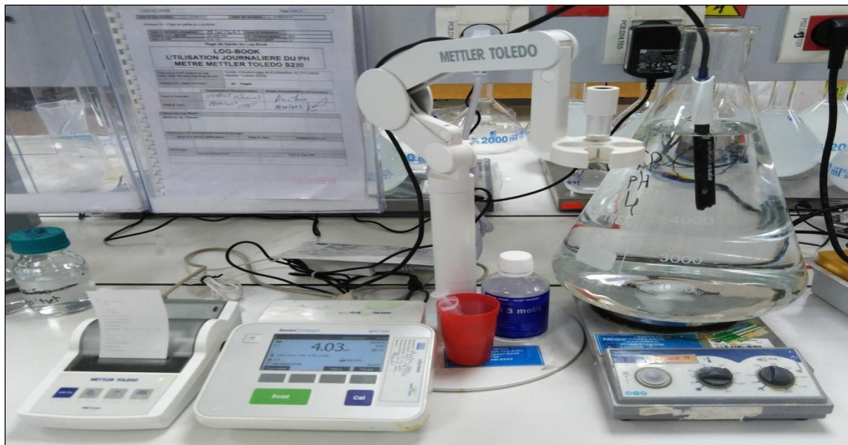
Figure 16 : schéma préparation de la phase mobile (photo personnelle).
