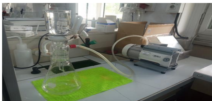
Figure III.1 : Système de filtration sous vide
