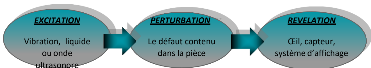
Fig. XIII.3 : Principe de CND
