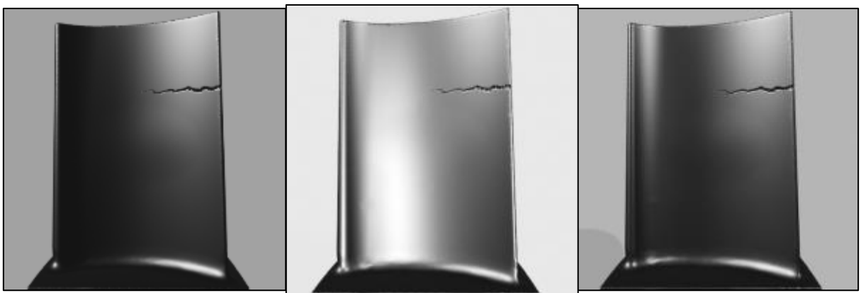
Figure III-3: Modèles générés avec Blender montrant différentes conditions d'éclairage pour mettre en évidence les défauts
