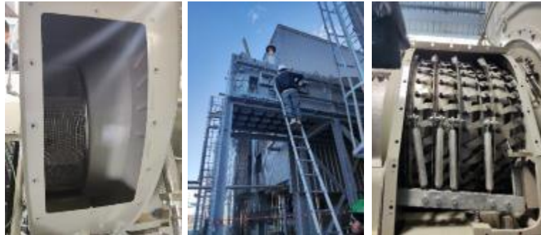
Figure II-11: Configuration de l'espace de travail pour la préparation de l'inspection par Boroscope.
