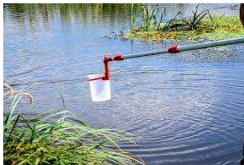
Figure 6.1. Prélèvement d'eau de lac représentatif avec un vase
