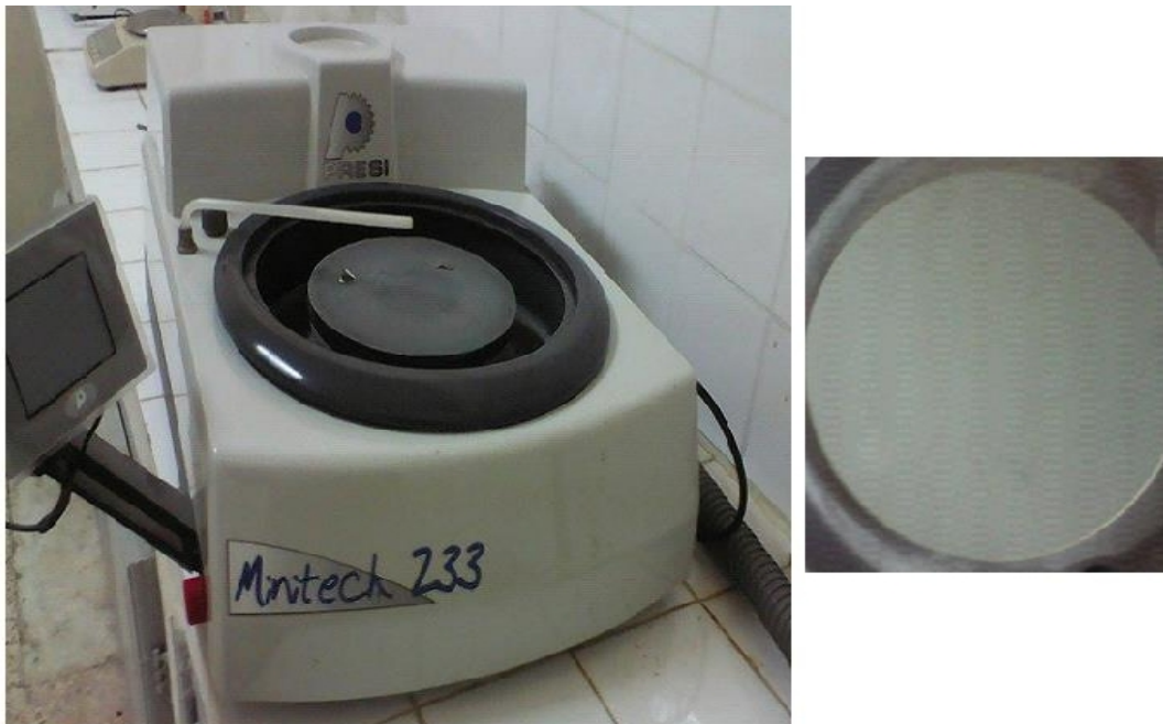
Figure 10 : Polisseuse Minitex 233 et papier abrasif SiC 1200(14 \mu m).
