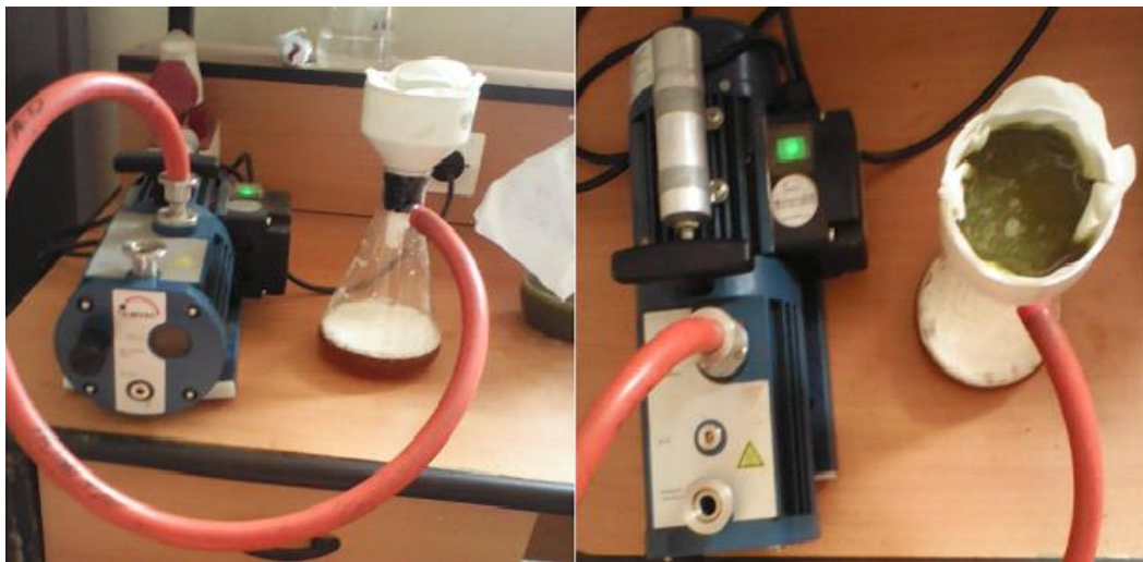
Figure 14 : Filtration sous vide du mélange d'extrait de feuilles d'olivier.
