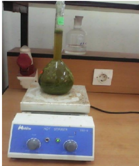
Figure 13 : Agitation du mélange de la solution de poudre de feuilles d'olivier.
