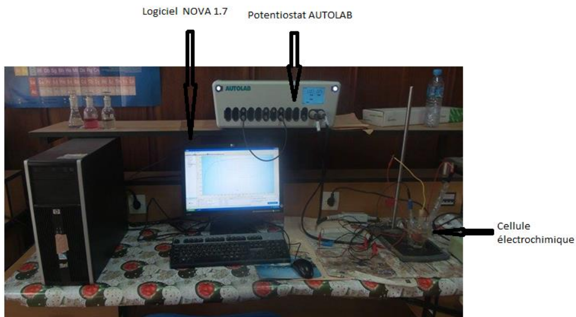
Figure 11 : Potentiostat AUTOLAB piloté par un micro-ordinateur et doté d'un logiciel NOVA 1.7.
