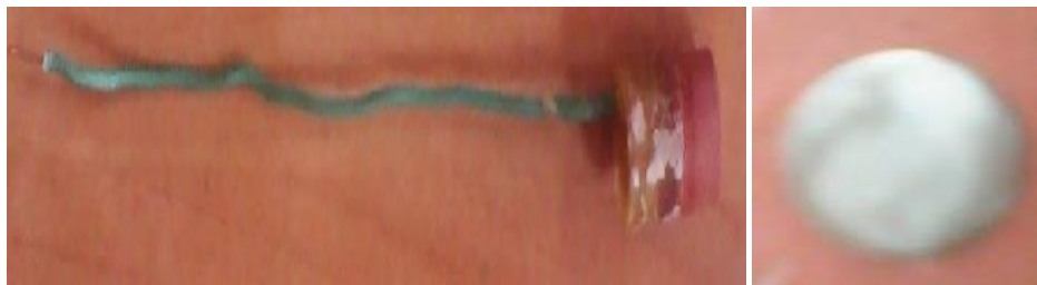
Figure 9 : Electrode de travail en Titane de grade 2.
