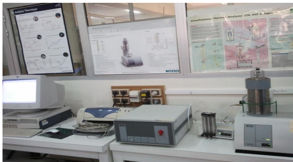
Figure I-10- représentation de l'appareille STA 409 PC
