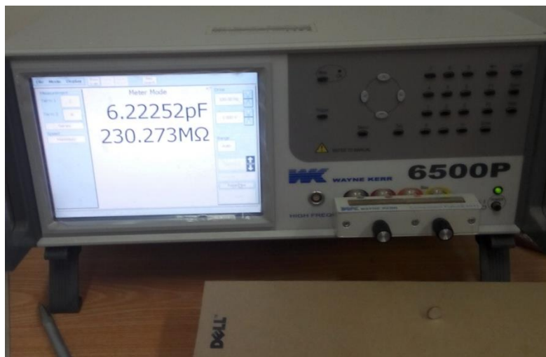
Figure IV-16 Montage utilisé pour les mesures de la capacité, la résistance et l'angle de perte
