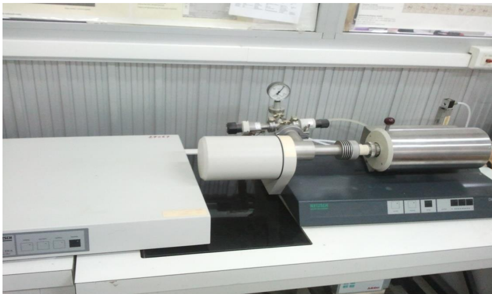
Figure II-11- : représentation de Dilatomètre 402 de NETZSCH
