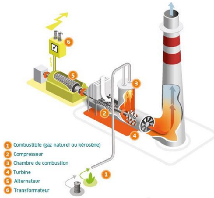
Figure III.15 : centrale thermique à gaz
