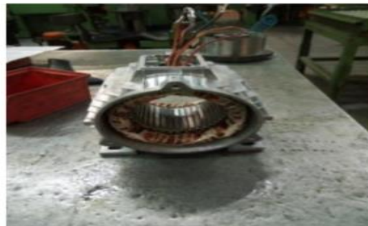
Figure I.14. Stator bobiné monté dans une carcasse
