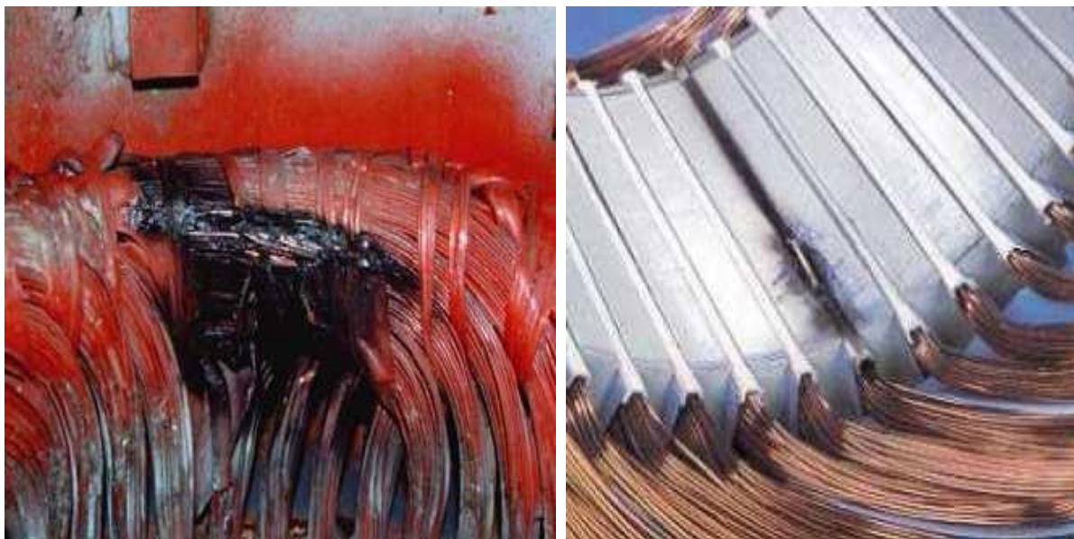
Figure. II. 13 Exemples de défaut de court-circuit statorique d'un MAS
