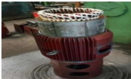
Figure I.15. Pré montage du stator dans la carcasse
