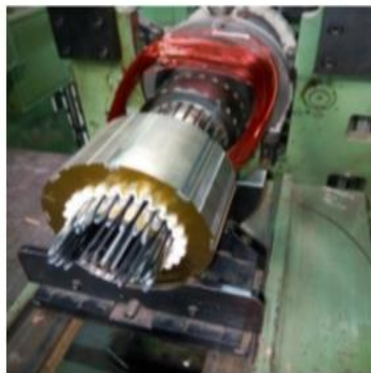
Figure I.12. Bobinage automatique d'encoche isolées
