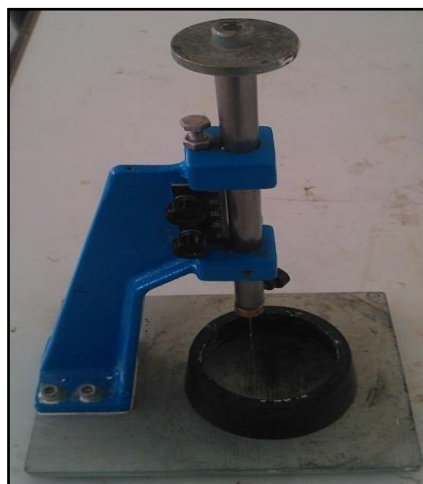
Figure 12 : Appareil de Vicat muni de l'aiguille amovible.
