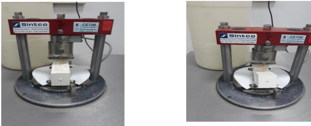
Figure 24 : Machine d'essai flexion avant et après coupure.
