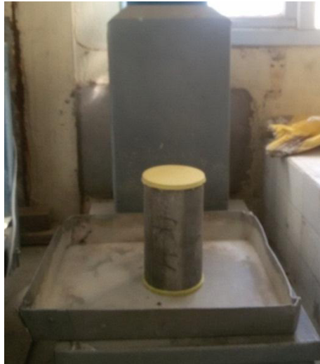
Figure I.21: Mesure de la masse volumique du béton durci.
