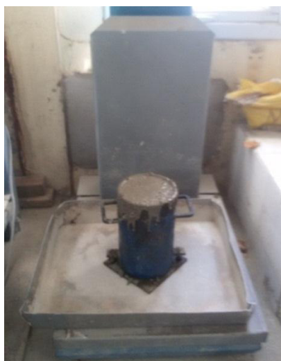
Figure II.10 : Détermination de la masse volumique de béton frais.
