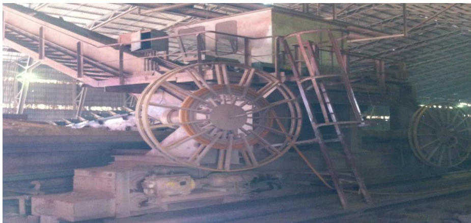
Figure II. 4 : Enrôleurs Des Câbles De Puissance Et Commande
