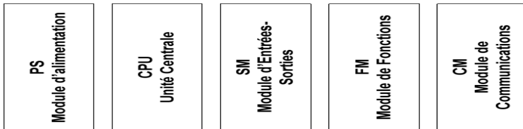
Figure III. 3 : Structure Intérieure d'un automate programmable
