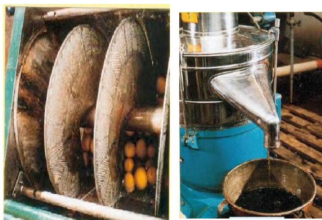
Figure II. 11: Presse hydraulique et centrifugeuse séparatrice utilisées dans l'expression à froid [47].
