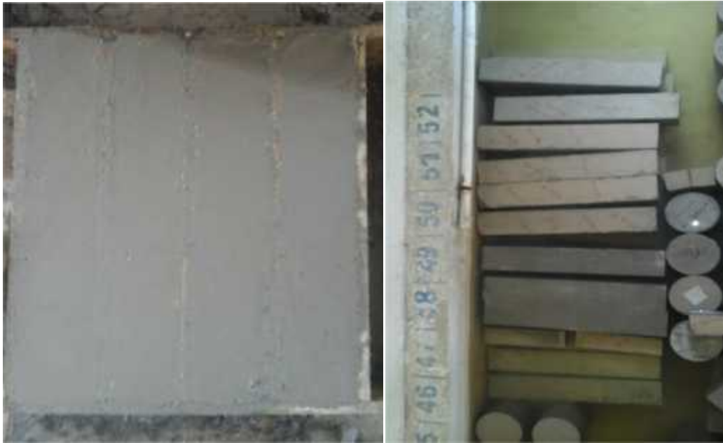
Figure II.11 : Murissement les poutres dans des bacs.
