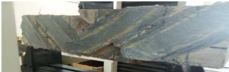
Figure II.38 : mode de rupture de poutre (P2CVI) par cisaillement décollement de composite
