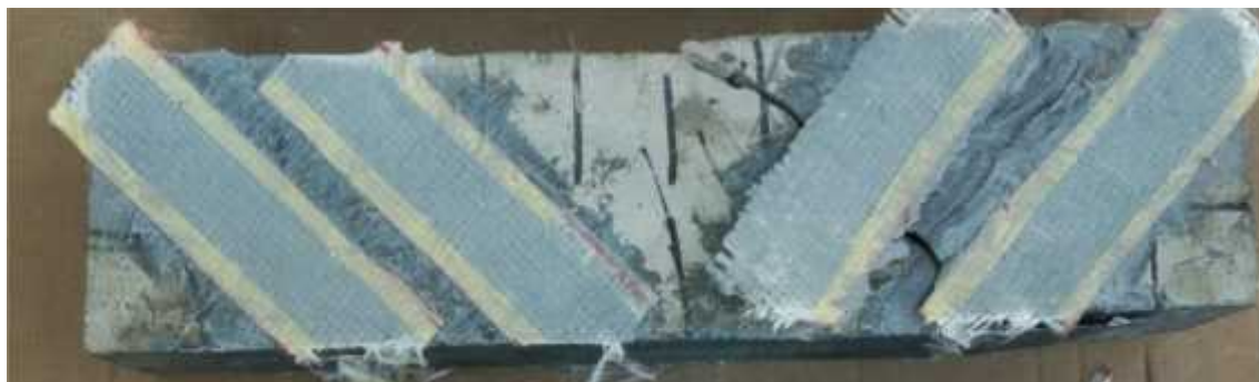
Figure II.28 : Mode de rupture des poutres (PICVI) Décollement de la résine du tissu et rupture par cisaillement
