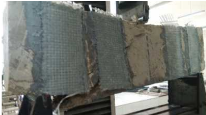
Figure II.26 : mode de rupture de poutre (P1CVD) arrachement des bandes puis rupture par cisaillement
