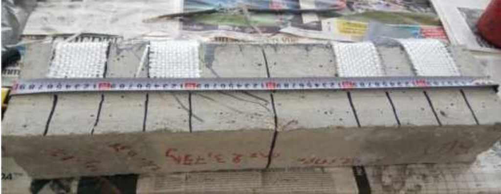
Figure II.21 : positionnement de fibre de verre sur la poutre
