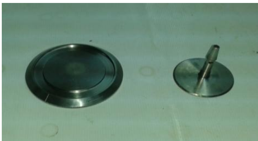
Figure III.5 : Géométrie cône-plane du Rhéomètre RS600.
