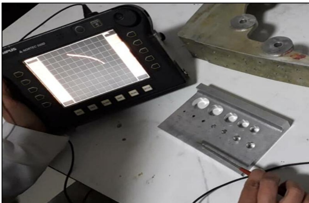
Fig.IV.30. Etalonnage d'une zone avec défaut
