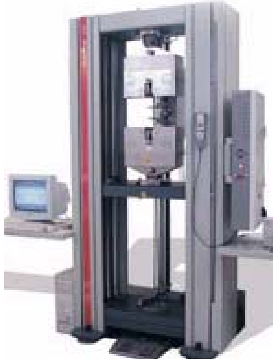
Figure II. 13 : Machine d'essai de traction-compression (Zwick / Z050).
