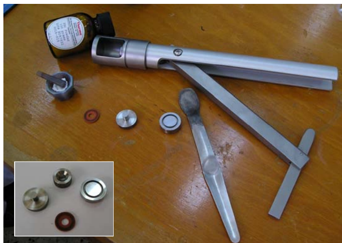
Figure II. 12: Presse et Accessoires utilisés dans la préparation des Pastilles en KBr.
