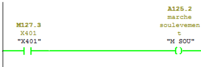
Figure V.25 : Réseau pour vérifier qu'il y a la demande de marche de soulèvement.
