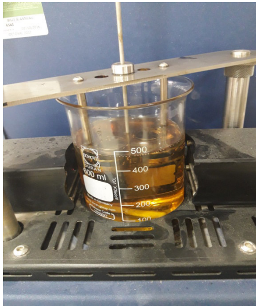
Figure II-15 : Flacon de glycérine place dans le dispositif de mesure de point de ramollissement
