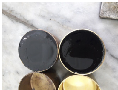
Figure II-7 : Gobelets remplis de bitume-polymère
