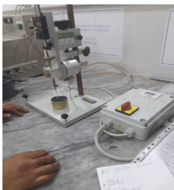
Figure II-5: Dispositif de mesure de la pénétrabilité
