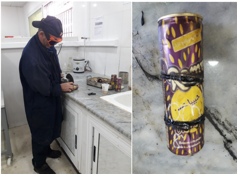
Figure II-25 : Prélèvement d'éprouvettes pour l'essai de stabilité au stockage
