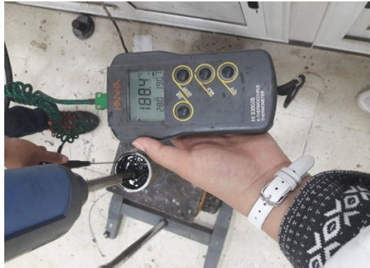
Figure II-6 : Mesure de température de mélangé (188 °c)
