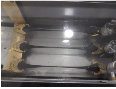
Figure II-21 : Eprouvettes de bitume étirées jusqu'à un allongement de 200 mm
