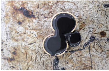
Figure II-10 : Anneaux remplis de bitume-SBS chaud
