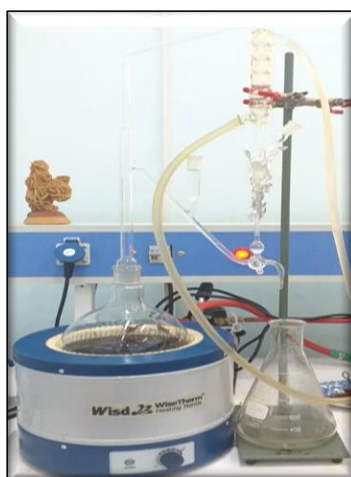
Figure 13 : Dispositif d'extraction de l'huile essentielle (PHOTO ORIGINALE, 2024)
