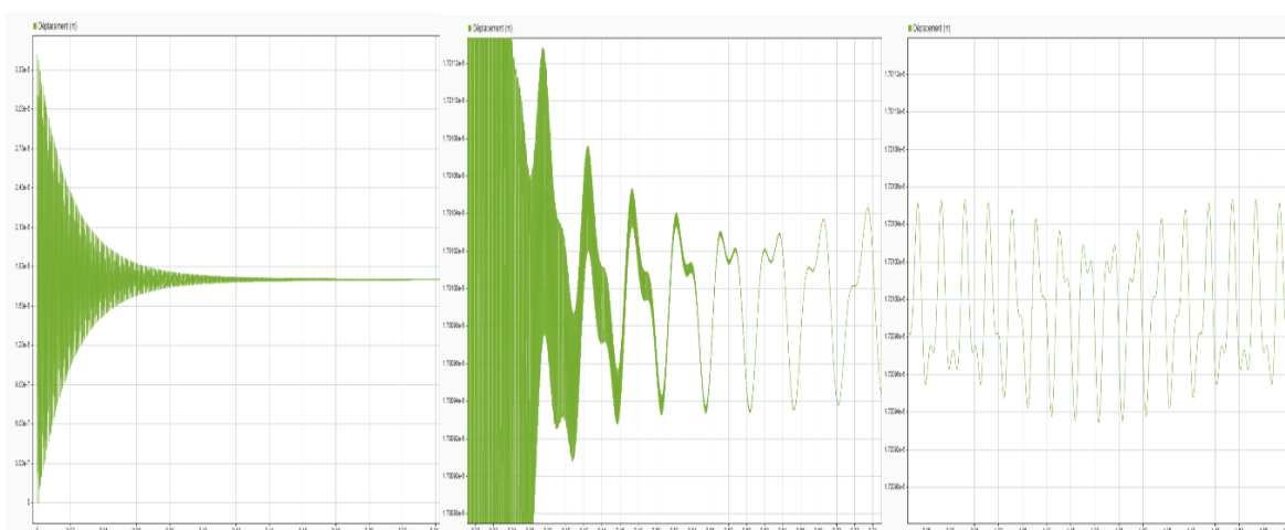
Figure III.54 – Butée avec lubrification et un défaut dans la cage pour 260 tour/min
