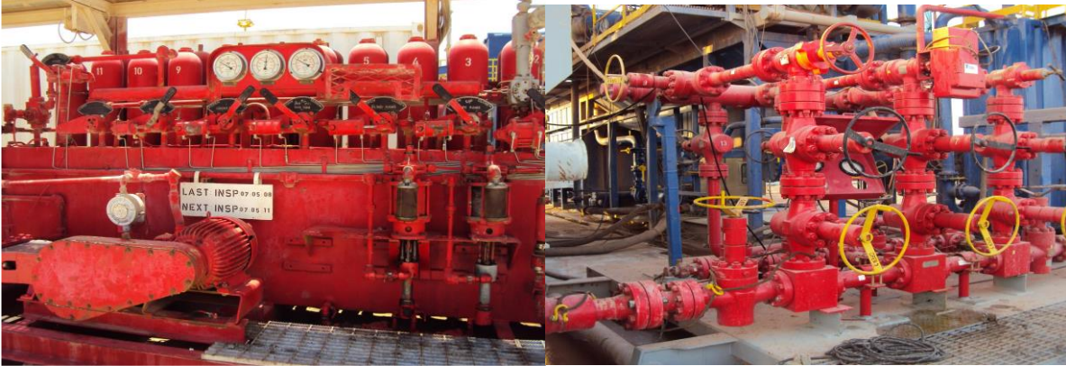
Figure I.11 – L'unité d'accumulation de pression ( kommey ) ; le choc manifold (ENF 45)
