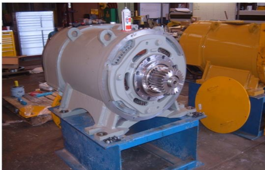
Figure III.5 – Moteur d'entraînement et pignon moteur [20]
