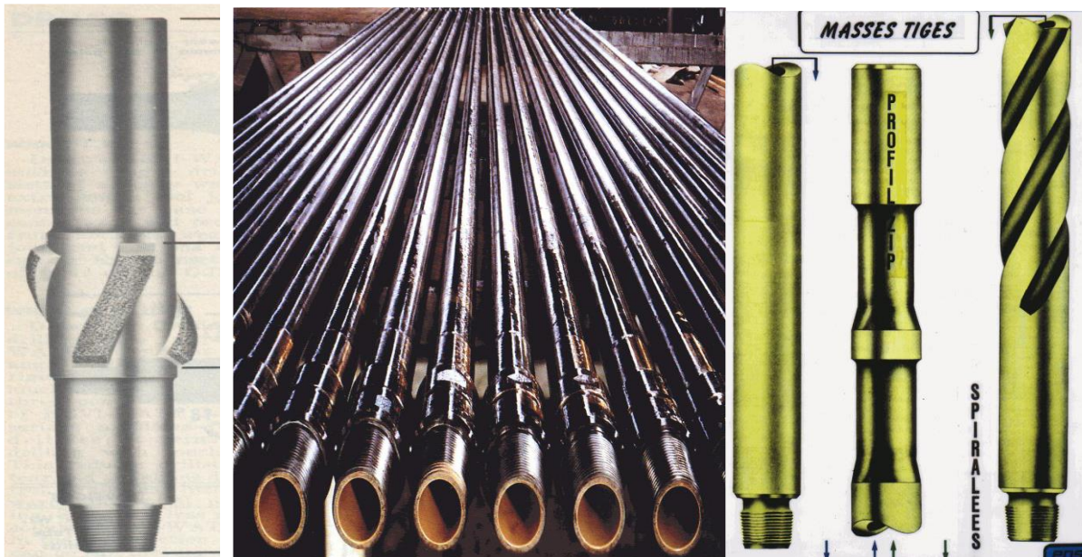
Figure I.2 – Stabilisateur ; Tiges de forage ; Masses tiges [4]
