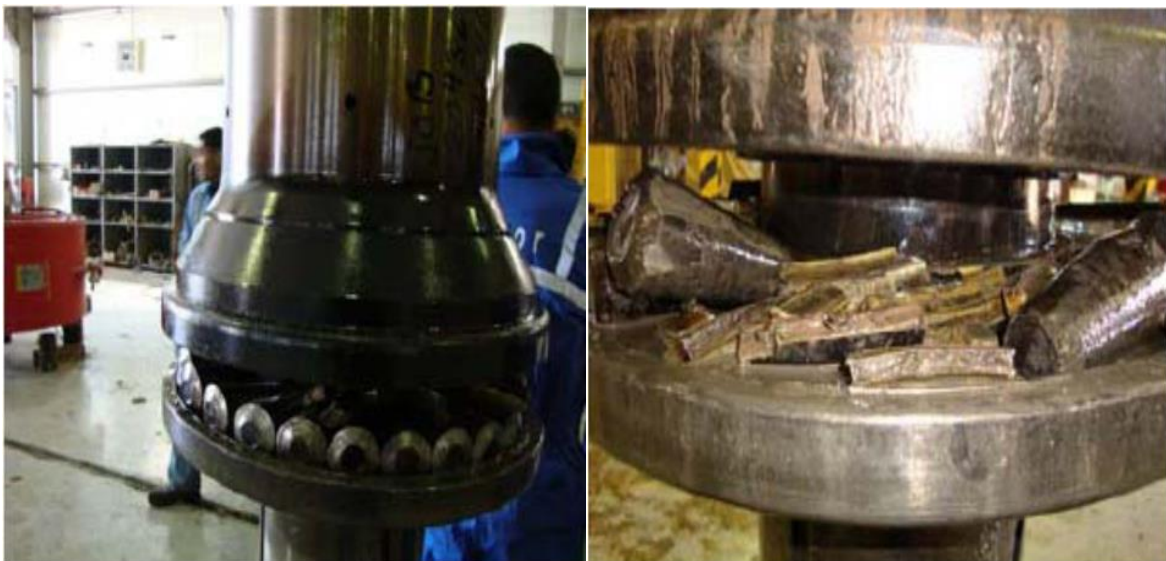
Figure III.30 – Butée complètement défaillante [27]
