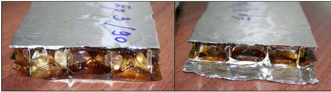
Fig. 10. La surface de la rupture de l'éprouvette en nid d'abeille 90° par rapport à l'axe ox
