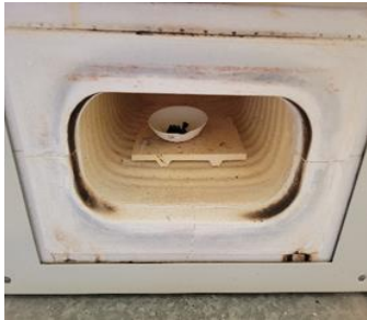
Figure III-5 : calcination des boues
