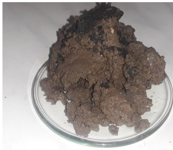
Figure III-1 : boues déshydratées des STEP boumerdes
