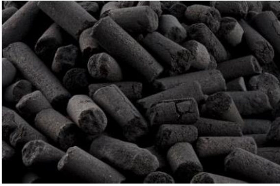
Figure II.4: image de charbon actif utilisé dans l'adsorption des polluents
