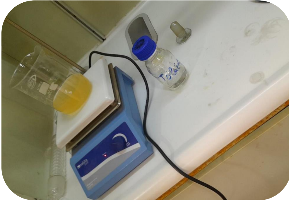
Figure III.1 : Montage expérimentale de la dégradation du toluène
