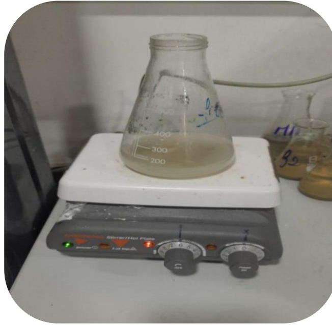
Figure III.2 : Montage expérimentale d'adsorption du toluène sur la bentonite
