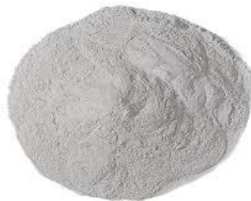
Figure II.3 : image de la bentonite utilisée comme adsorbant dans le traitement des polluants
