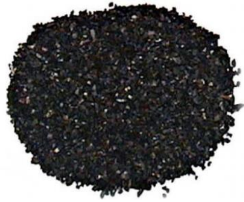
Figure II.4: image de charbon actif utilisé dans l'adsorption des polluents
