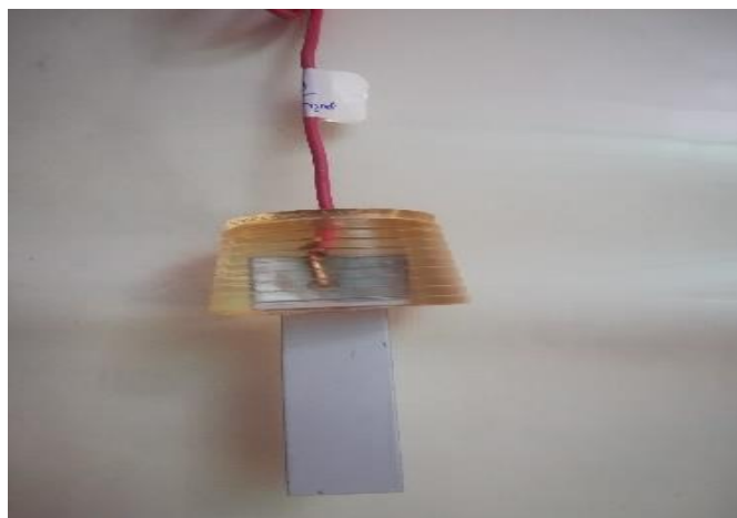
Figure.V.1. Electrode de travail revêtu par le primaire anticorrosion
