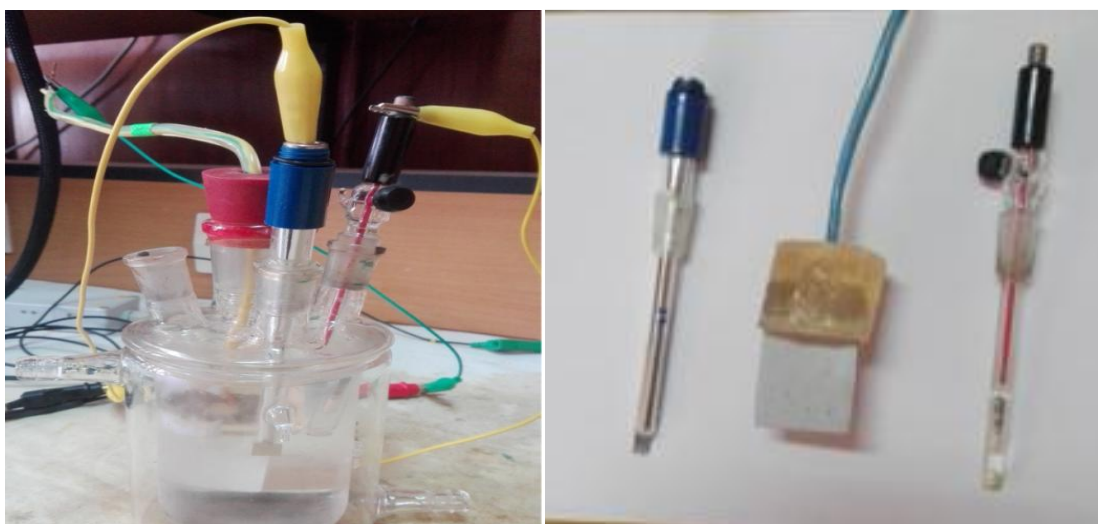
Figure V.2: Cellule électrochimique et les électrodes utilisées.
